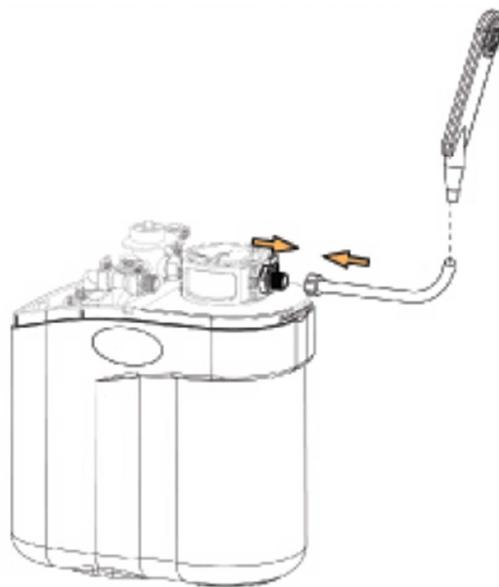
4. Verbinden Sie den Duschkopf und den Wasserausgang der Anlage. Entfernen Sie auch hier wieder zuerst den roten Sicherungsclip und verbinden diesen anschließend wieder. Stellen Sie sicher das während der Installation kein Wasser fließt.
