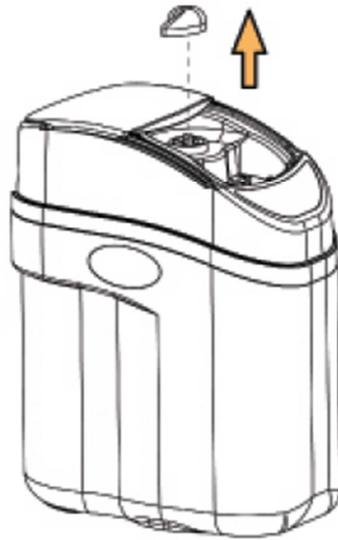
1. Platzieren Sie das Gerät am gewünschten Aufstellort. Schieben Sie die Klappe des Deckels nach oben und entfernen Sie den Regenerationsknopf in senkrechter Bewegung.
