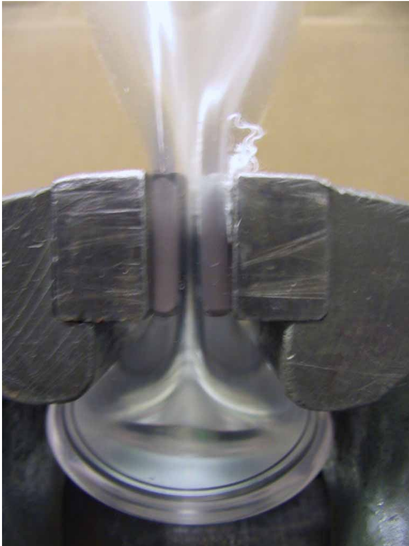
Gehäusetasse bricht selbst beim Test im Schraubstock nicht, sondern verformt sich nur.
