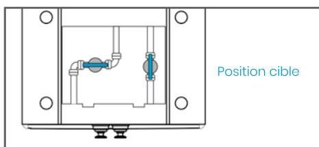
Pour une conversion en „raccordement mobile" l'entrée d'eau (n° 3) et la sortie d'eau (n° 4) doivent être fermées avec un bouchon pour éviter les fuites d'eau. Pour pouvoir retirer à nouveau le tuyau, vous devez d'abord retirer le clip de sécurité (voir page 22).
