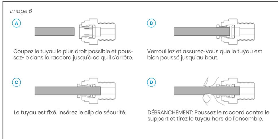
Chaque connexion rapide est équipée d'un clip de sécurité spécial pour la fixer et la sceller. Veuillez vous assurer que le clip est présent et correctement placé après le montage (voir image ci-dessous). La dimension d'insertion du tuyau est d'environ 19 mm.
