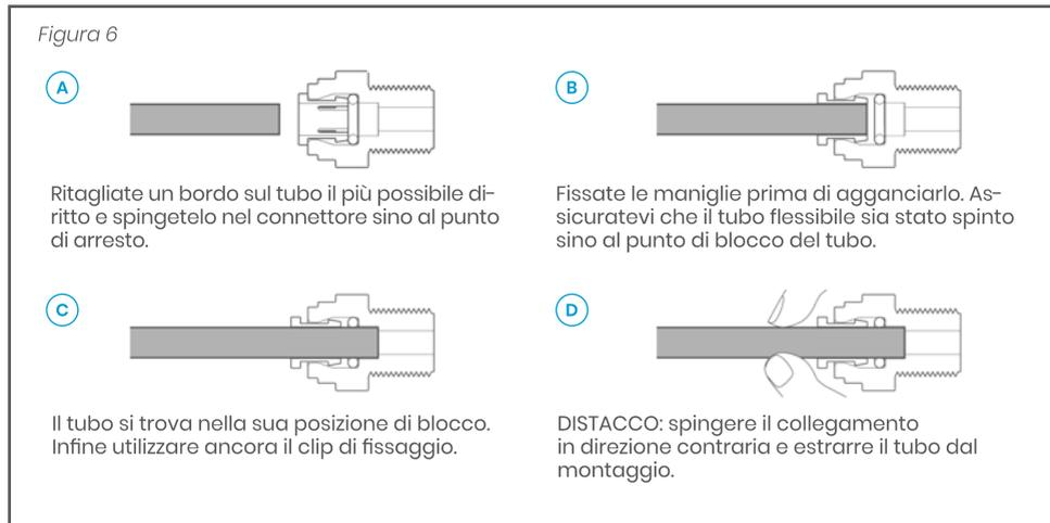
Per la sicurezza e la sigillatura ogni attacco rapido Quick-Connect è dotato di un clip di fissaggio particolare. Una volta completato il montaggio prestate attenzione alla presenza e al corretto posizionamento del clip di fissaggio (vedere la figura sotto). La dimensione di incasso del tubo è di 19 mm.
