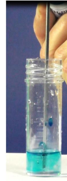
Der Test des Gehalts an molekularem Wasserstoff mit dem optional erhältlichen H<sub>2</sub> blue<sup>®</sup> Kit wird unmittelbar nach der Produktion durchgeführt. Dazu füllt man vorsichtig eine Wasserprobe von 6 ml in den Messbecher und gibt einen Tropfen der blauen Messflüssigkeit dazu. Zur Erzielung einer gleichmäßigen Tropfengröße sollte man das Tropffläschchen möglichst senkrecht halten. **Jeder Tropfen, der sich entfärbt, bedeutet 0,1 ppm (=100 ppb) gelöstes Wasserstoffgas.**
