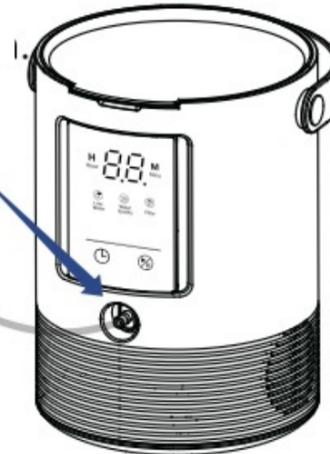
5 Verbinden Sie die Nasenkanüle mit dem H2 Ausgang. Setzen Sie die Nasenkanüle auf. (Siehe folgende Seite)
