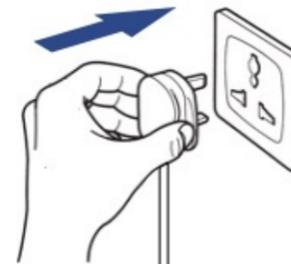
6 Stecken Sie den Netzteiladapter in die Buchse für den Netzteilanschluss. Stecken Sie den Netzteilstecker in das Netzteil. Stecken Sie den Netzstecker in eine 100 – 240 V Steckdose. Ein kurzer Quittungston ertönt.
