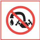
**Befestigungseinheit niemals waschen.** Die Befestigungseinheit der Sana Ölpressen darf nicht nass werden. Legen Sie die Befestigungseinheit nie in Wasser/Flüssigkeit und schützen Sie sie vor Wasserspritzern. Feuchtigkeit kann zu Rost in dem in der Befestigungseinheit verschraubten Lager führen.
