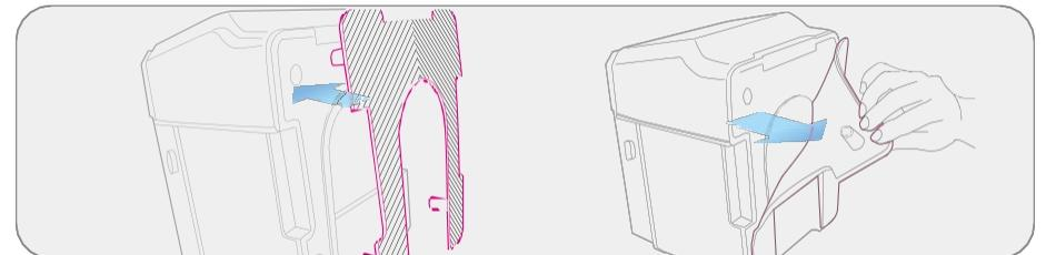
1 Setzen Sie den Fußgummi in die Rillen am unteren Boden des Gehäuses ein.
