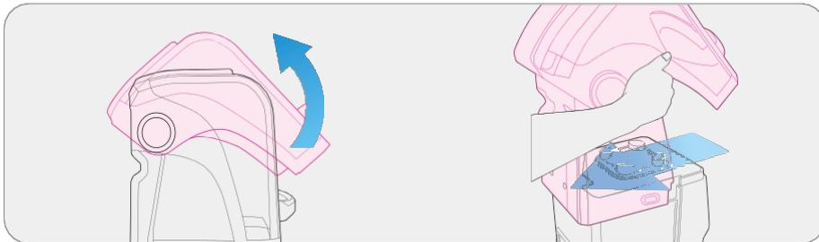
1 Öffnen Sie bei abgenommenem Behälter die Schallschutzhaube leicht nach oben.
