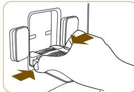
③ Haken Sie die Tropfschale in die Nut ein und lösen Sie eine Hand von der Tropfschale, um sie zu befestigen.
