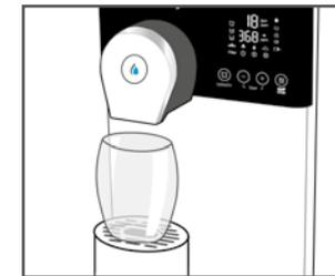
1. Salida de agua: coloque su recipiente debajo de la boquilla de salida izquierda.
