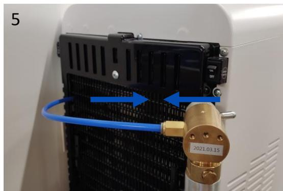
3. Verbindung mit dem CO2-Zylinder:
