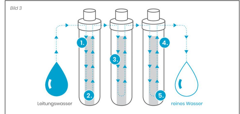
Abbildung smardy blue Filterstufen
