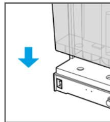
1. Entnehmen Sie den Wassertank aus der Maschine.
