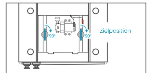
Für eine Umstellung auf „mobiler Anschluss“ muss der Wasserzulauf (Nr. 3) und Wasserablauf (Nr. 4) mit einem Stopfen verschlossen werden, um Wasseraustritt zu verhindern. Um den Schlauch wieder entfernen zu können, müssen Sie zuerst die Sicherungsklammer entfernen (siehe Seite 17).
