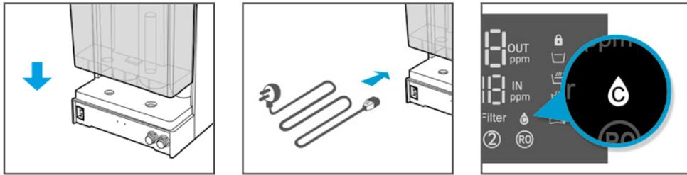
**i HINWEIS:** Der Reinigungsvorgang startet nun automatisch und dauert ca. 10 Minuten. Nach Ablauf des Vorgangs blinkt das Symbol „G“ im Display.
