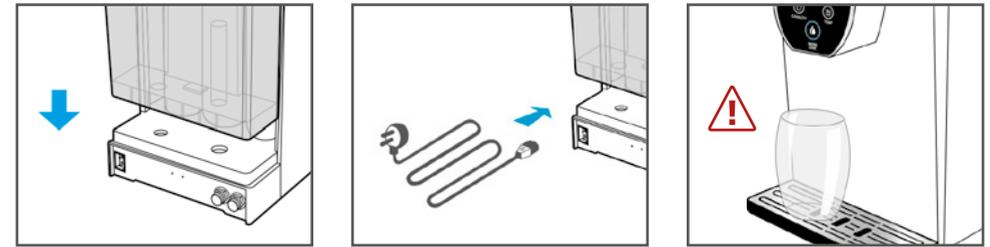
**! ACHTUNG:** Nach dem Reinigungsvorgang ist es notwendig die Anlage mit kaltem Leitungswasser durchzuspülen. Hierfür lassen Sie bitte 3 bis 4 VOLLE WASSERTANKS durch die Anlage fließen. Dieses Spülwasser ist nicht zum Verzehr geeignet.
