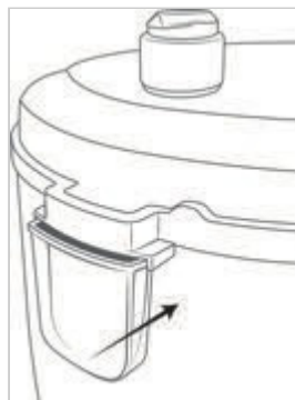
Abbildung 5: Das Einsetzen des Kondensatbehälters
