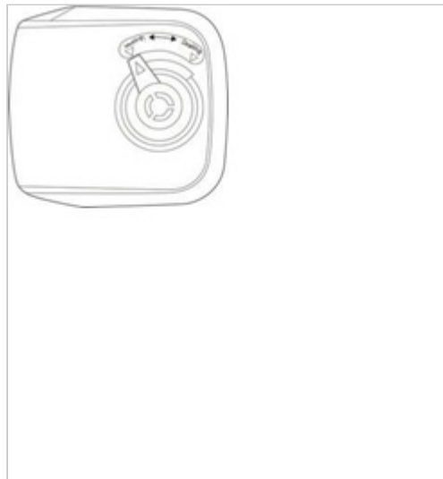
Abbildung 7: Das Schließen des Dampfventils (von links nach rechts schieben)
