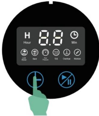
1. Drücken Sie Taste UHRZEIT mehrfach, bis Sie die gewünschte Inhalationszeit erreicht haben. Sie können wählen zwischen 30, 60 und 90 Minuten, sowie zwischen 2 und 3 Stunden (hrs).
