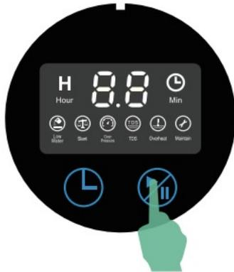
2. Drücken Sie die Taste START/PAUSE zum Start der Inhalation. Nach Ablauf der eingestellten Uhrzeit stoppt der Betrieb automatisch. Sie können den Betrieb aber auch manuell durch erneutes Drücken der START/STOP Taste beenden.
