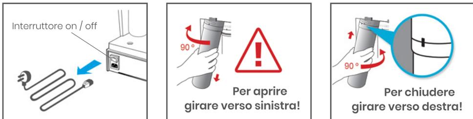
3. **Preparazione e riempimento con la soluzione detergente:** Riempite il contenitore con circa 4 litri di acqua corrente e mettete infine la soluzione detergente **smardy blue Save&Clean** (ottenibile separatamente – non compresa con la consegna) riponete quindi nuovamente il contenitore dell'acqua nell'impianto.
