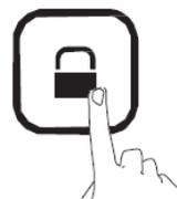
→ Um die Eisproduktion auszuschalten, drücken Sie die Sensortaste für die Schlossfunktion für **10 Sekunden**. Die Produktion neuer Eiswürfel endet sofort. Bereits vorhandene Eiswürfel werden noch ausgegeben, bis der Vorratsbehälter leer ist, es sei denn die Schlossfunktion ist aktiviert. Es ertönt ebenfalls ein akustisches Signal und die LED leuchtet nun nicht mehr.
