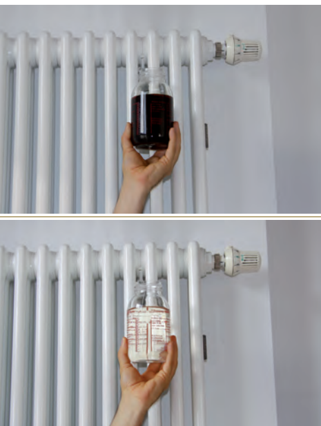
HEIZUNGSWASSER OHNE UMH HEIZUNGSWASSER MIT UMH
