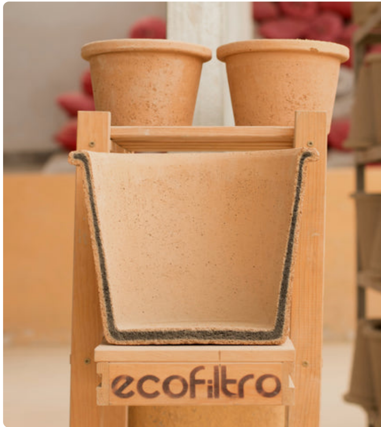
Die Keramik-Filtereinheit: Poröser Ton mit Aktivkohle und kolloidalem Silber
